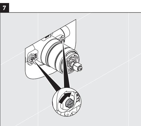
> Encienda las válvulas de control del agua caliente y de la fría girándolas en el sentido horario.
