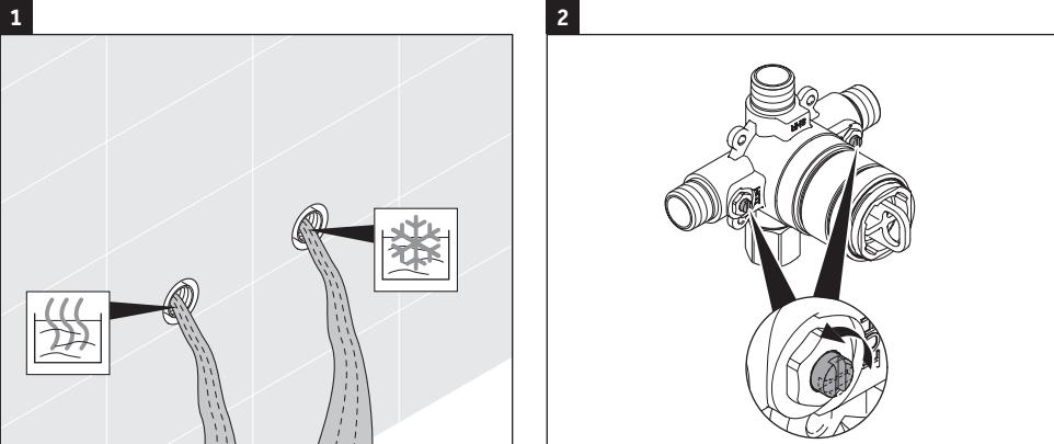
> Antes de instalar la válvula, asegúrese de purgar las líneas de agua fría y caliente para limpiarlas de residuos y sedimentos.
