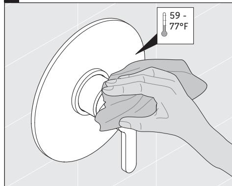
> La temperatura de limpieza óptima se sitúa entre 15 °C y 25 °C (59 °F y 77 °F).
