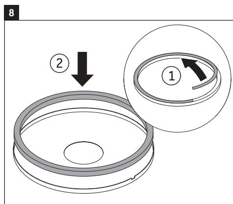
> Junta unida a la placa de cubierta.
