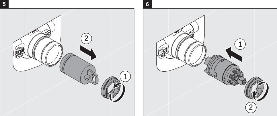
> Retire la cubierta de protección del mando desenroscando y retirando la tuerca de bloqueo.
